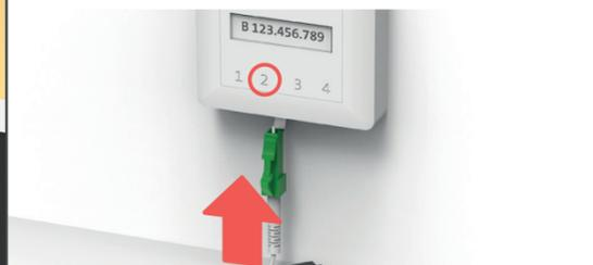
Funziona in un solo slot: togli il cappuccio di protezione. Sulla presa in fibra ottica, apri lo slot predefinito (in generale il «2», raramente l'«1»). Importante: se le porte sono posizionate in alto, lo slot 2 è il secondo da destra. Per rimuovere il cavo, vedi retro. **1**
