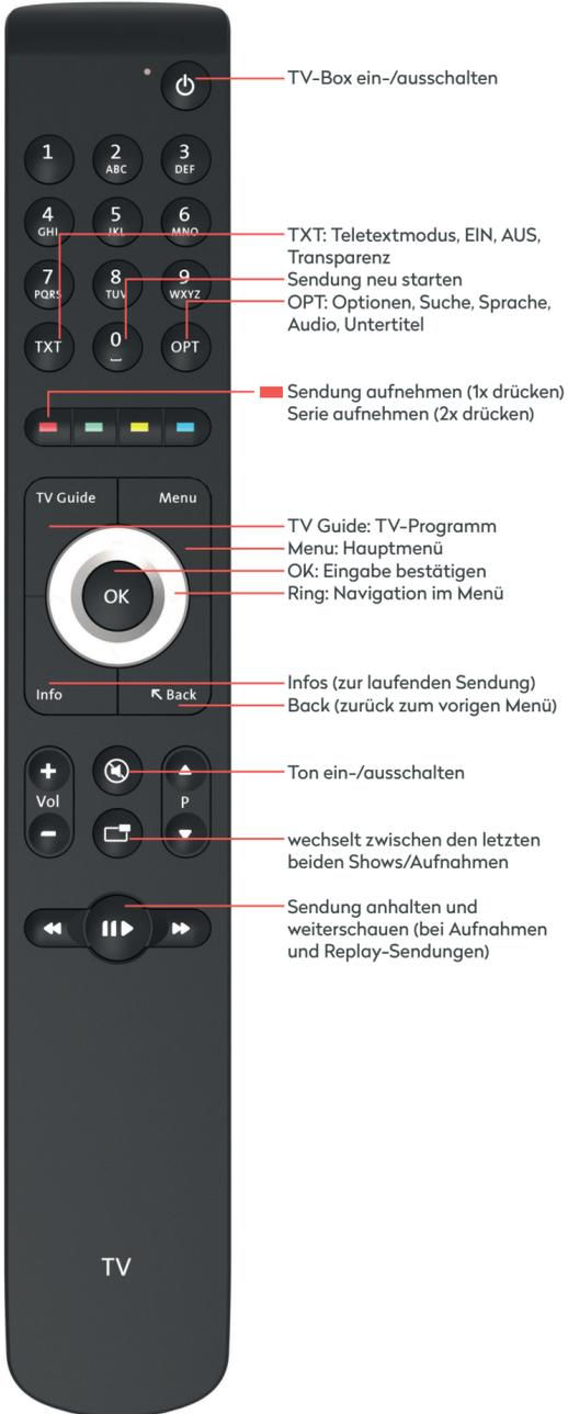
Es ist kein Sichtkontakt zwischen TV-Box und Fernbedienung nötig. Die Verbindung zwischen Fernbedienung und TV-Box läuft über Bluetooth. Die beiden Geräte benötigen keine Sichtverbindung. Also ab in den Holzschrank, meide Metallwände.
